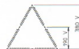
Verlaagd ontdooivermogen (elementen in de aansluitkast ompolen).
